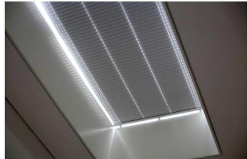
Die innenliegende Beschattung **GLASOLUX GSB24V** wird aus hochwertigem Polyestergewebe als Wabenplissee gefertigt. Sie ist UV-stabil, antistatisch beschichtet (staubabweisend) und in verschiedenen Farbtönen erhältlich. Der 24 Volt-Antrieb ist verdeckt im Profil platziert, die Führung erfolgt über filigrane Nylonkabel.
